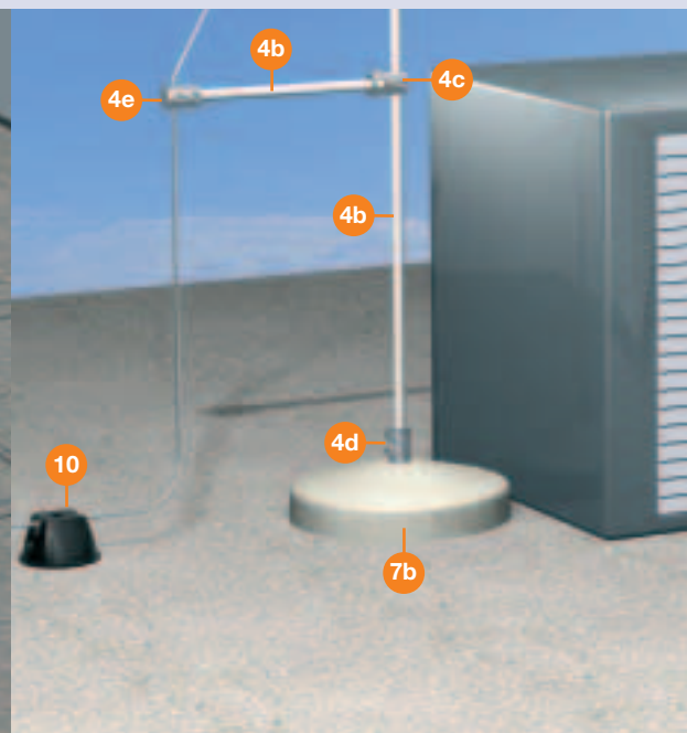
Изолированный стержневой молниеприемник на опоре
